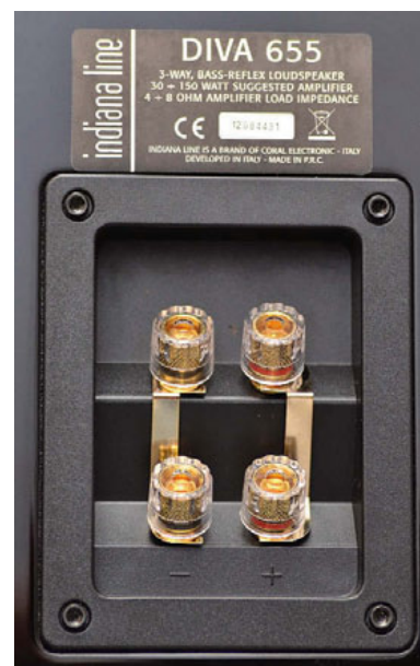
I morsetti d'ingresso sono duplicati per collegamenti biwiring.
